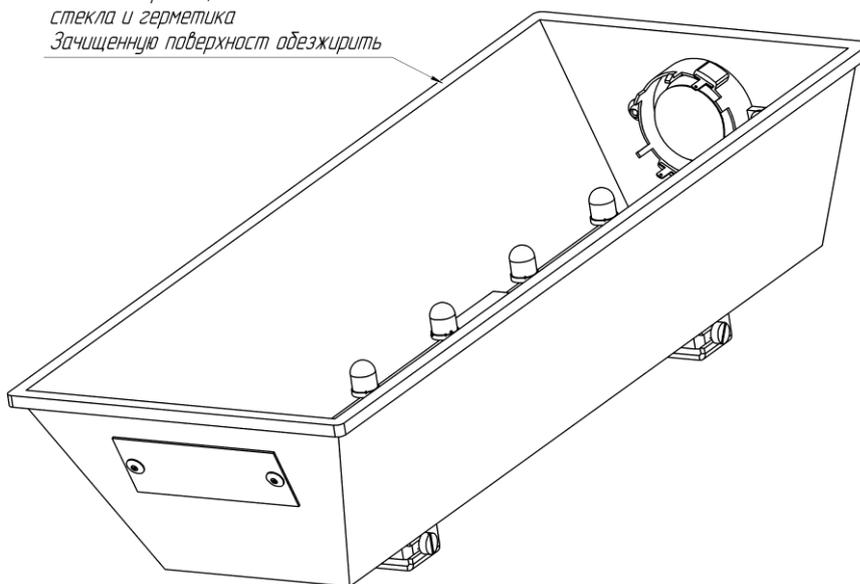
4 Обезжирить спиртом фланец корпуса оповещателя, будущее место примыкания рамки со вклеенным стеклом с надписью (табло-панель) Рис. 2.
