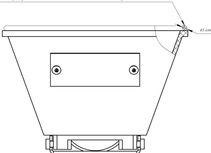
6 Установить новую рамку со стеклом (табло-панель) на фланец с нанесенным силиконовым герметиком до фиксации защелок расположенных на рамке Рис. 4.
