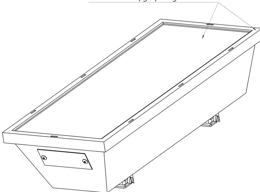
3 Очистить фланец корпуса извещателя от остатков силиконового герметика и стекла. Рис. 2.
